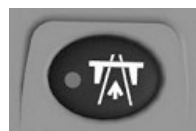
H121089—UN—15MAR17 Interrupteur de sécurité route/champs (style A)
