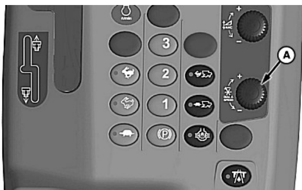
A —Molette de vitesse automatique des tapis/du rabatteur
