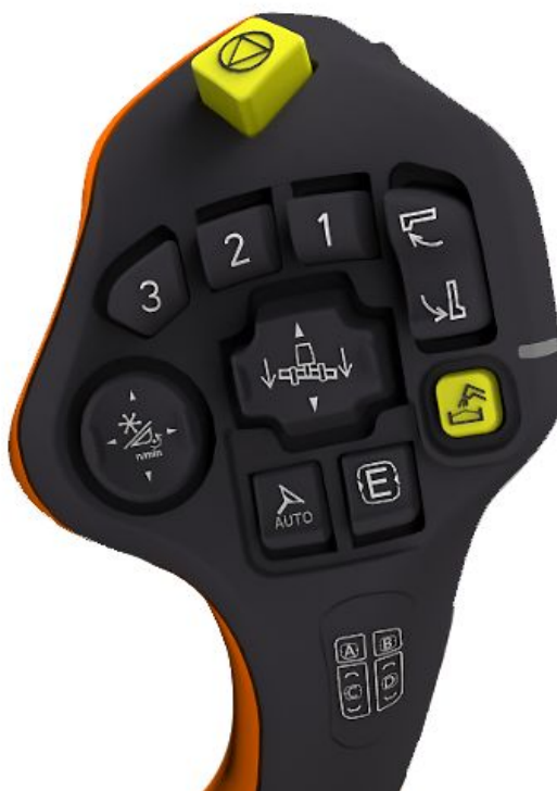
Pulsante di ripristino sulla macchina (recente)
