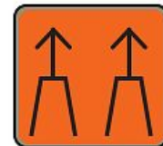
Perdita segnale sensore filari, in funzione solo con GPS
