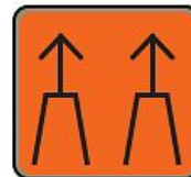
Потерян сигнал датчиков рядов, работа только по данным GPS
