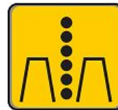
Потеряны данные GPS, работа только по данным датчиков рядов
