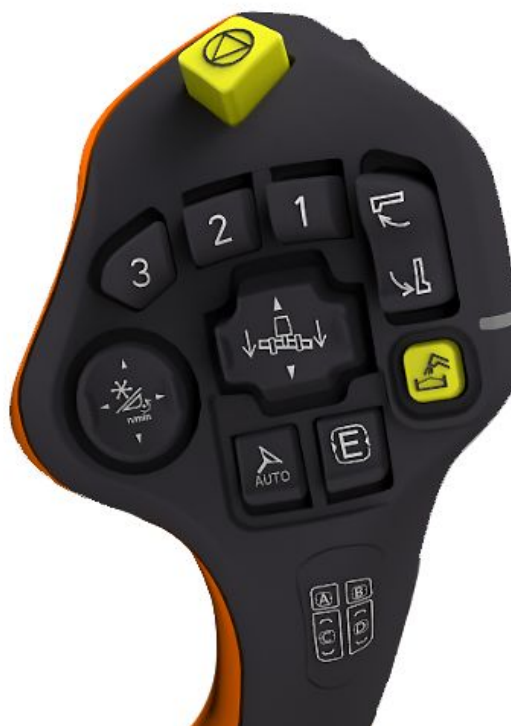
Przycisk przywracania w maszynie (nowsza wersja)
