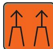
Brak sygnału czujników rzędu, praca tylko przy użyciu GPS
