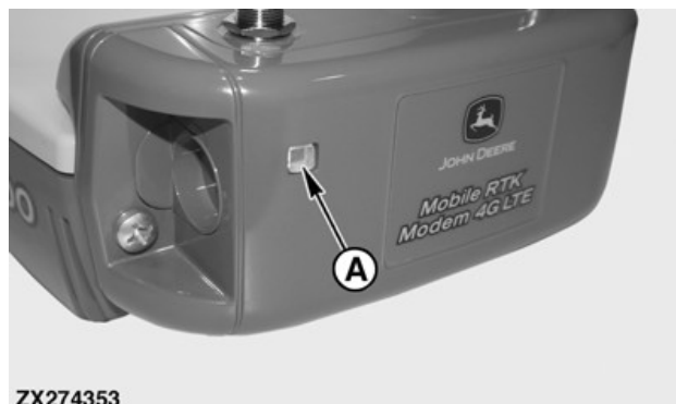
Modem RTK Móvel—Descrição do Status do LED
