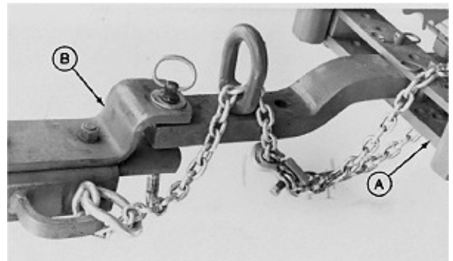
A—Soporte de la barra de tiro B—Enganche de la sembradora
