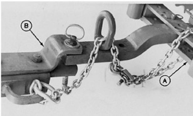
A—Support de barre d'attelage B—Relevage
