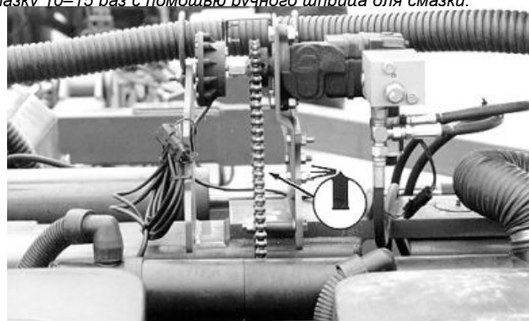
Роликовая цепь регулируемого привода (если он установлен)
