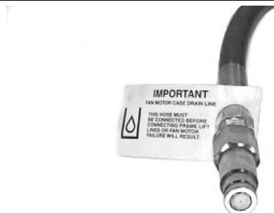
Фитинг сливного шланга корпуса, устанавливаемый заподлицо с внутренней поверхностью
