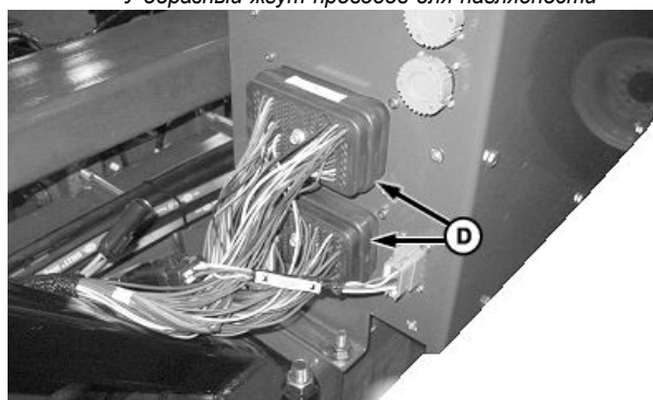
У-образный жгут проводов для наглядности
