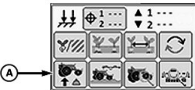
Bouton Pression vers le bas (pression pneumatique vers le bas à point de consigne double)
