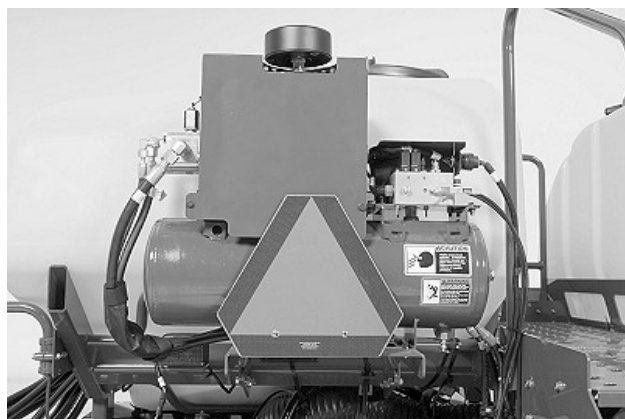
A72531—UN—12SEP11 Compresseur d'air, réservoir d'air et électrovanne de pression pneumatique vers le bas - Semoirs tractés avec CCS™ (pression active vers le bas)
