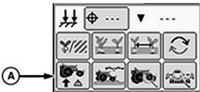
Bouton Pression vers le bas (pression pneumatique vers le bas à point de consigne unique)
