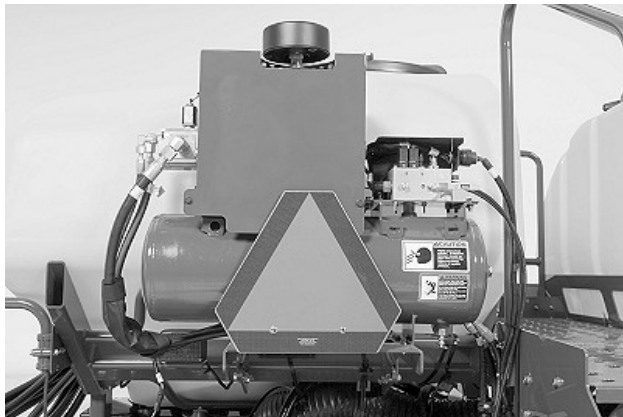
A72531—UN—12SEP11 Compresor de contrapresión neumática, depósito de aire y electroválvula de control - Sembradoras remolcadas con CCS™ (contrapresión activa)
