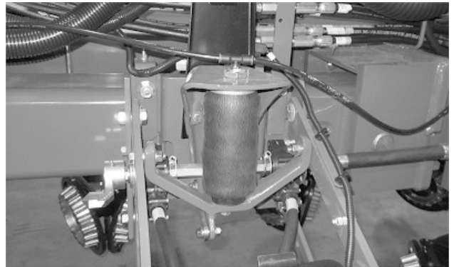
Пневмопругину правильно розтягнуто на нижньому кріпленні
