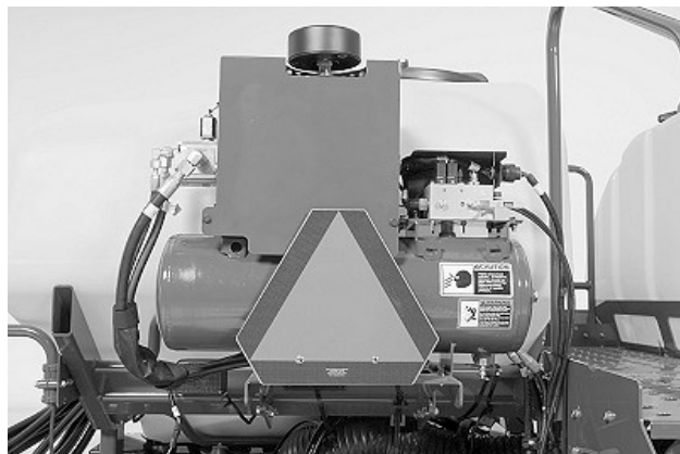
Повітряний компресор, повітряний бак та електромагнітний клапан управління системою пневматичного притискання - причепна сівалка з CCS
