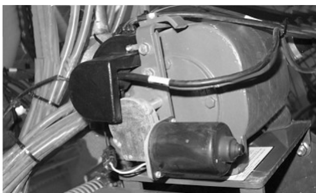
A67690—UN—11JUN10 可変速施肥ポンプ変位アクチュエータ、センサー
