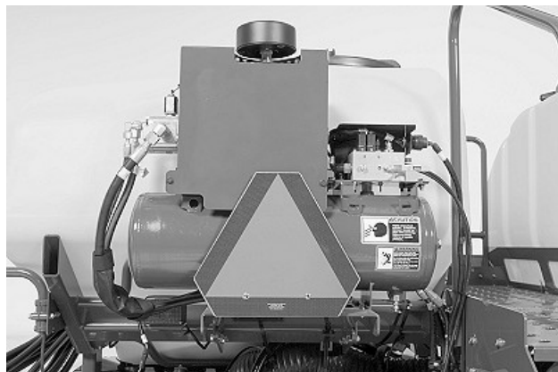
A72531—UN—12SEP11 空圧式ダウンフォースエアコンプレッサ、エアタンク、ソレノイド制御弁：牽引式播種機 CCS
