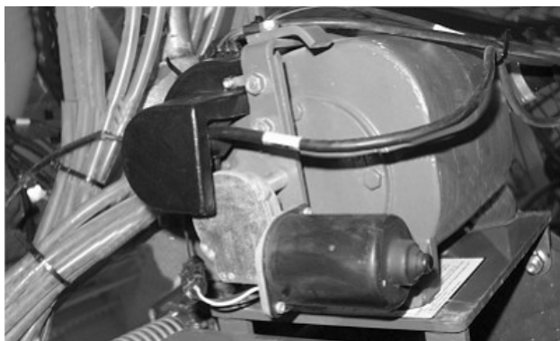
Változtatható mennyiségű műtrágya szivattyúlókat beállító működető elem és érzékelő
