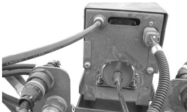
Pneumatikus talajnyomás fokozó kompresszor (Integrált egy alapértékes pneumatikus talajnyomás-fokozó rendszerrel ellátott gépeknél)
