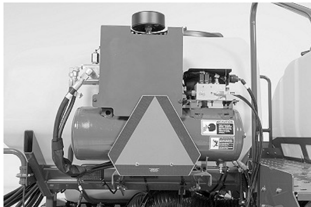
A72531—UN—12SEP11 Compresor de aer sistem pneumatic de deportanță, rezervor de aer și ventil electromagnetic de control – plantatoare tractate cu CCS
