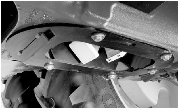
A67664—UN—11JUN10 Radar cu Fascicul Dublu John Deere
