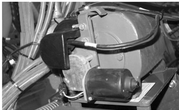
A67690—UN—11JUN10 Mecanism de acționare și senzor al debitului pompei distribuitorului de îngrășământ cu rată variabilă
