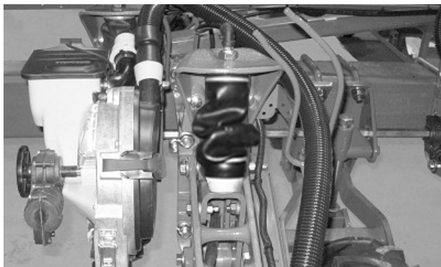
Resort pneumatic rulat necorespunzător (două rânduri)
