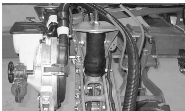
Resort pneumatic rulat corespunzător (două rânduri)
