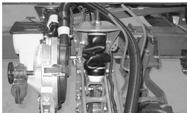
Неправильно расправленная пневматическая пружина (двухрядный посев)
