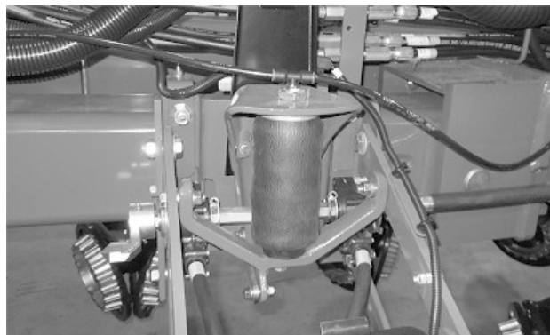
Правильно расправленная пневмопружина на нижнем креплении
