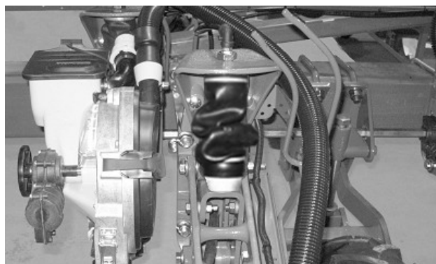
Неправильно расправленная пневматическая пружина (сеялки двухрядного посева)
