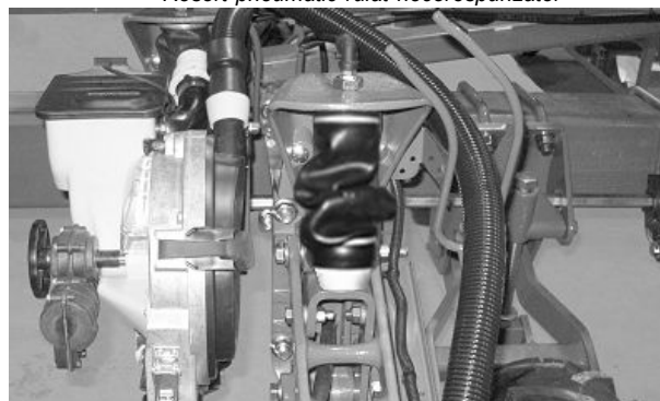
Resort pneumatic rulat necorespunzător (două rânduri)
