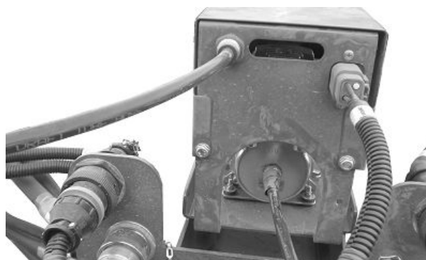
Compresor de aer (sistem de deportanță cu valoare setată unică)
