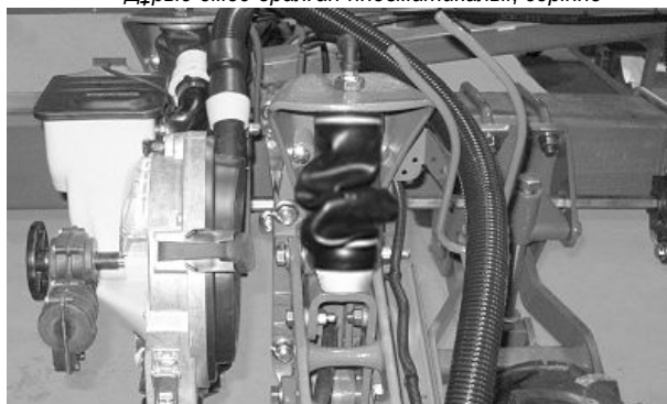
Дұрыс емес оралған пневматикалық серіппе (Егіз қатар)
