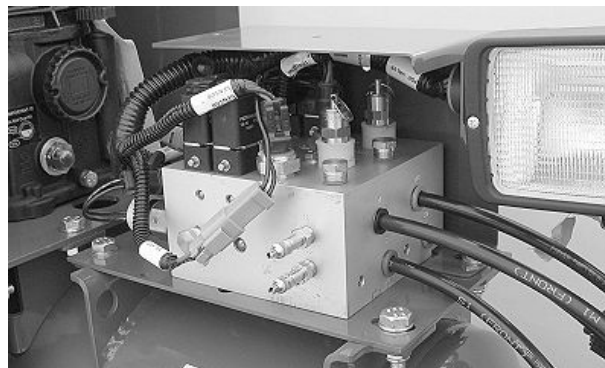
Пневматикалық төменгі күш қысым датчиктері (Белсенді төменгі күш) (Қос орнату нүктелі клапан көрсетілген)
