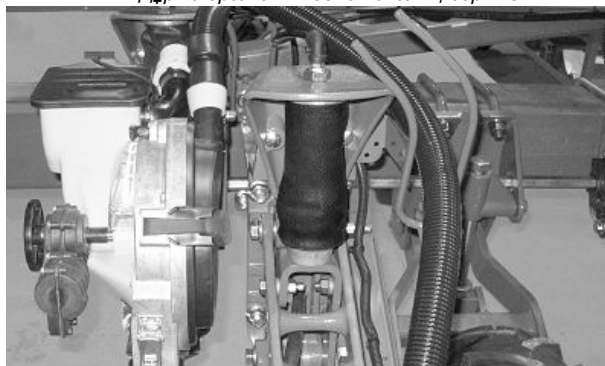
Дұрыс оралған пневматикалық серіппе (Егіз қатар)
