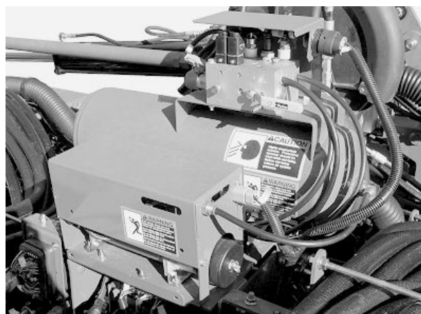
Пневматикалық төменгі күш ауа бағы және электромагниттік басқару клапаны - Біріктірілген сепкіштер (Жалғыз орнату нүктелі біріктірілген пневматикалық төменгі күші бар машиналар)
