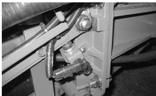
Конечный выключатель высоты параллельного рычага для навесных двухрядных сеялок
