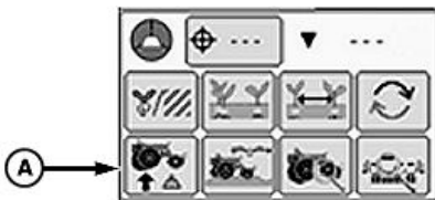
Кнопка прижима (активный PDF с одним датчиком)
