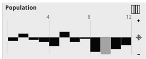
Balkendiagramm für Sädichte
