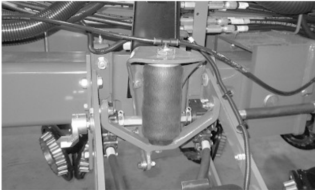
Muelle neumático enrollado correctamente
