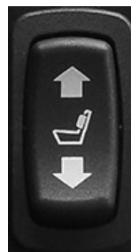
Control de ajuste lumbar hacia arriba/abajo
