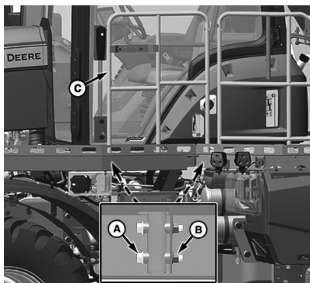
A—Tornillo (se usan seis) B—Contratuercas (se usan seis) C—Sección de pasamanos central
