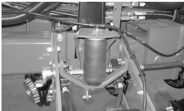
Пружина встановлена належним чином
