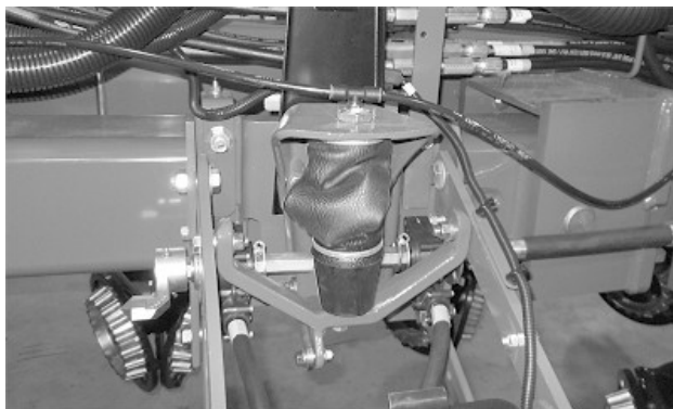
Пружина встановлена неналежним чином
