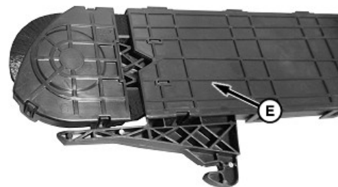
A—Arbore de antrenare B—Cuplaj motor C—Conectorul cablajului D—Senzor de Semințe E—Cartuş BrushBelt™
