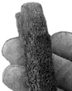
A100144—UN—21MAR18 Uzură asimetrică între laturi
