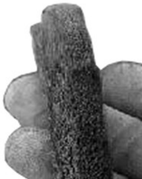
A100144—UN—21MAR18 Uzură asimetrică între laturi
