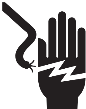
Pericol de șoc electric
