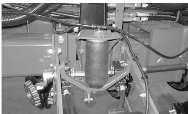
Resort pneumatic rulat corespunzător
