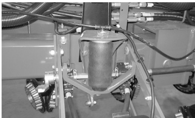
Правильно скрученная пневмопружина
