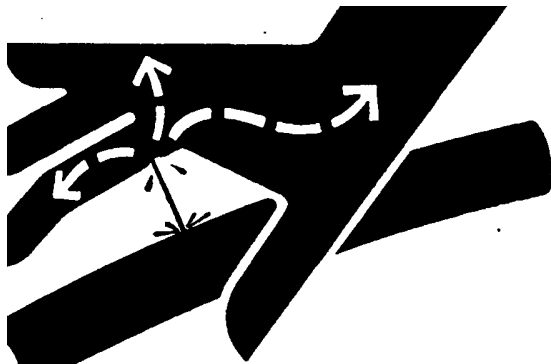
Опасность контакта с жидкостью под высоким давлением X9811—UN—23AUG88
