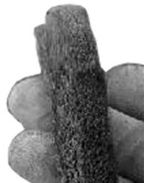
Неравномерный поперечный износ
