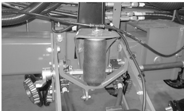
Правильно скрученная пневмопружина
