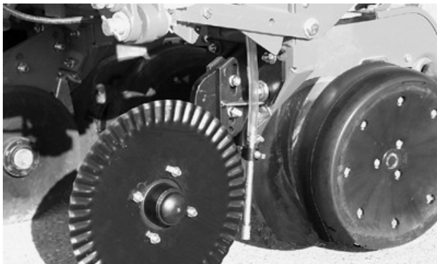
A96394—UN—02MAY17 Інжекційний сошник (поруч з борозною для посівного матеріалу)
