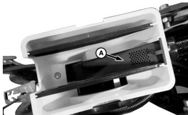
A—Entrada de la tolva
