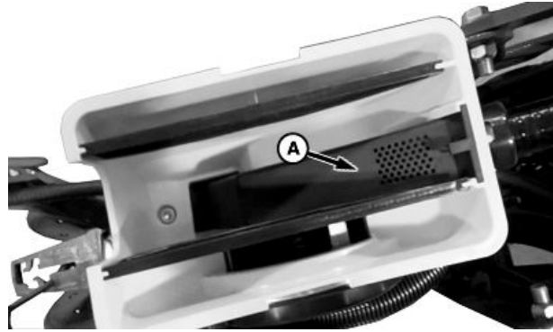
A—Entrada de la tolva
