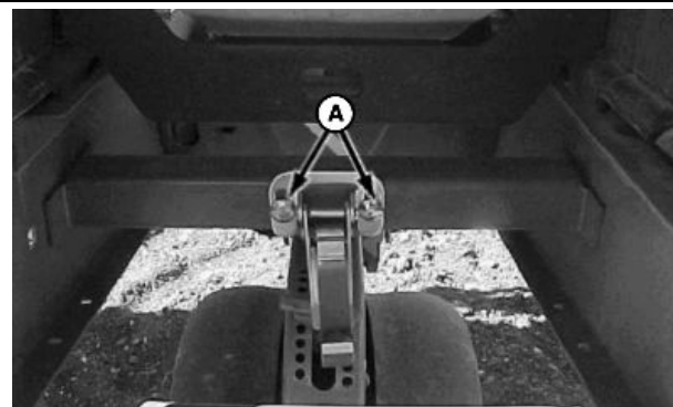
Dispozitivul de blocare a containerului de 106 l (3.0 bu)
