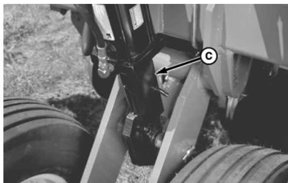
Замки для обслуговування коліс відкидних секцій
