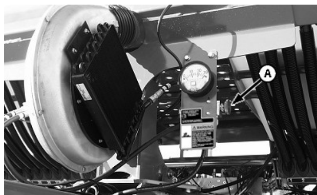
А—Ручка клапана регулювання витрати
