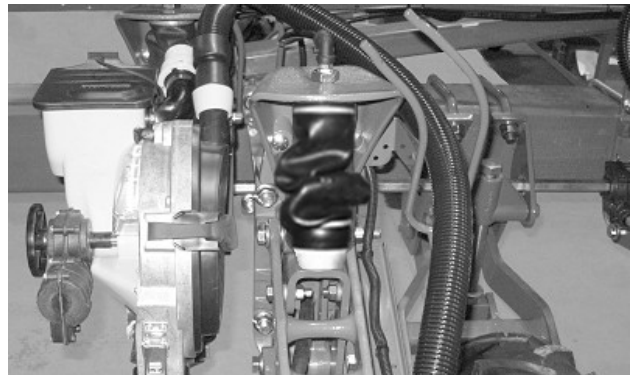
Пневматична пружина встановлена неправильно (просапні сівалки для дворядкового висівання)
