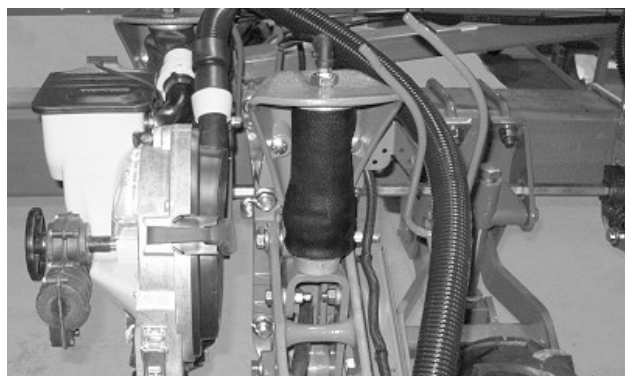
Resort pneumatic rulat corespunzător (plantatoare cu două rânduri)
