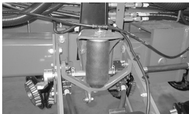
Resort pneumatic rulat corespunzător peste soclul inferior
