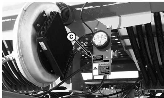
Перемикач вентилятора CCS — усі виробу серії DB за винятком DB120
