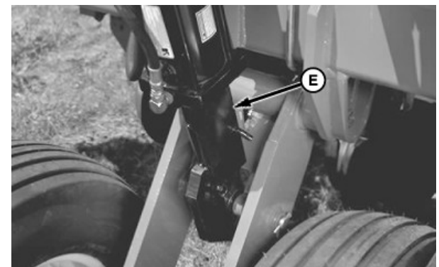
Замки для обслуговування коліс відкидних секцій
