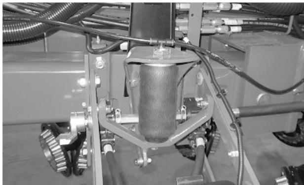
Пневмопругину правильно розтягнуто на нижньому кріпленні
