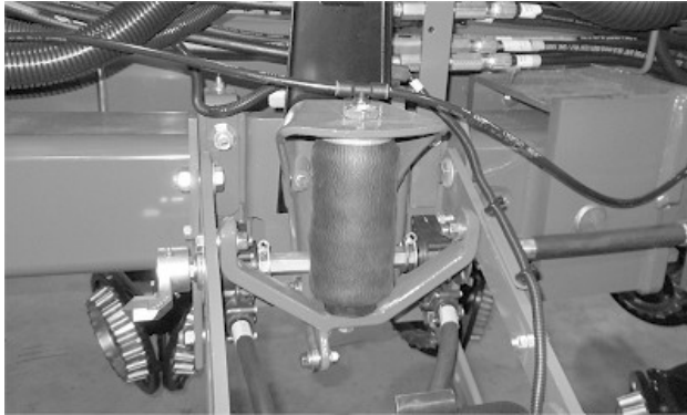
Пружина встановлена належним чином
