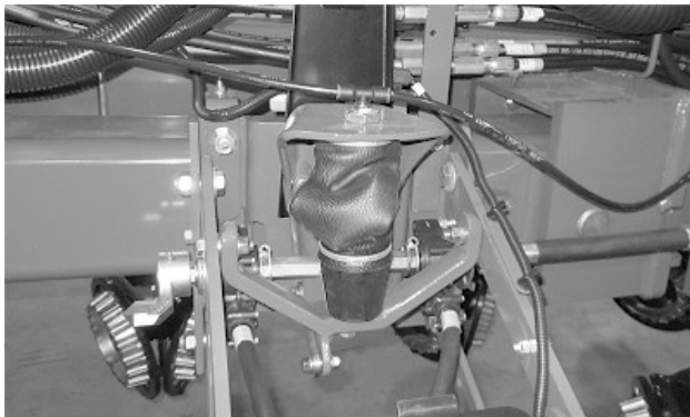
Пружина встановлена неналежним чином
