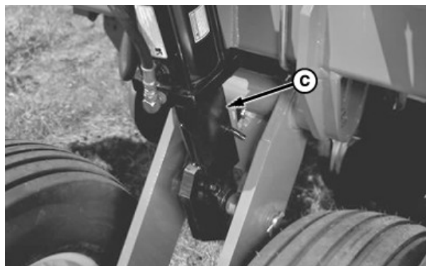
Замки для обслуговування коліс відкидних секцій
