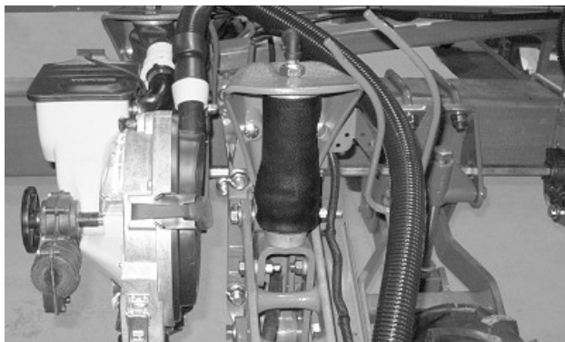
Пневматична пружина встановлена правильно (просапні сівалки для дворядкового висівання)
