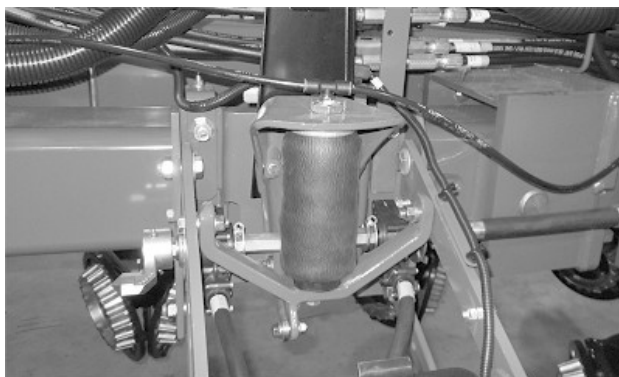
Ауа серіппесі төменгі тірекке дұрыс оралған
