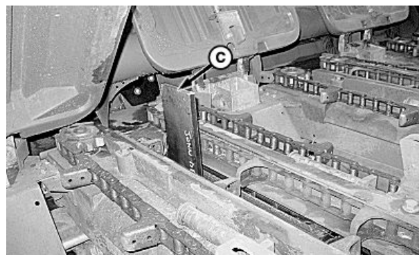
Pokazano odkręcanie lewej nakrętki ustalającej
