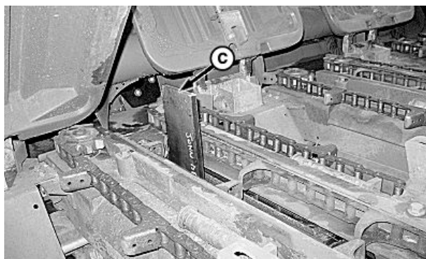
Ausbau der linken Sicherungsmutter abgebildet
