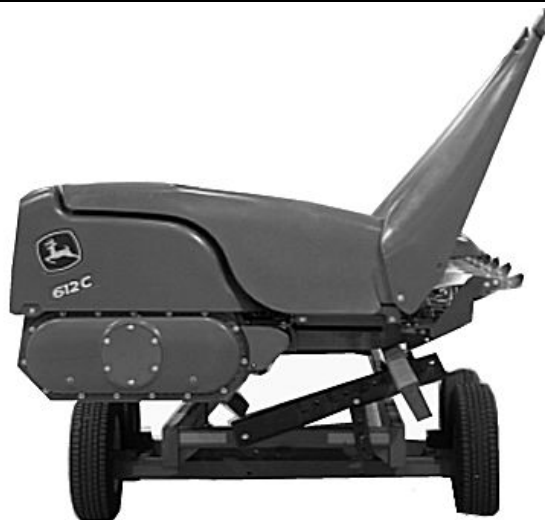
Abbildung zeigt Stängelteilerspitzten für den Transport eingeklappt
