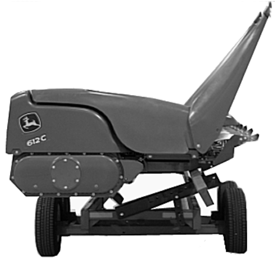
Puntas mostradas plegadas para el transporte
