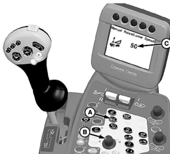
A—Interruptor de ajuste de velocidad y de ajuste de sensibilidad del alimentador B—Selector
