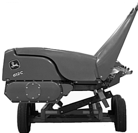
Orrok felhajtása szállításhoz
