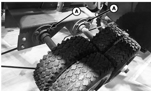
A—Точки смазки (по 2 с каждой стороны)
