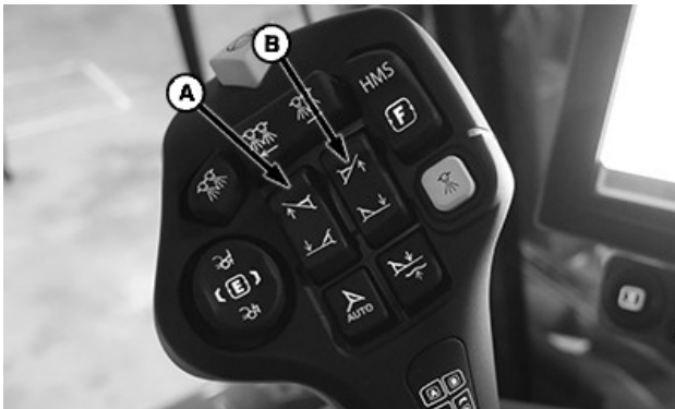
А—Лівий перемикач вирівнювання В—Правий перемикач вирівнювання
