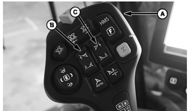
А—Перемикач переналаштування А В—Лівий перемикач вирівнювання С—Правий перемикач вирівнювання
