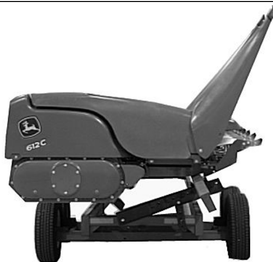
Pointes montrées repliées pour le transport
