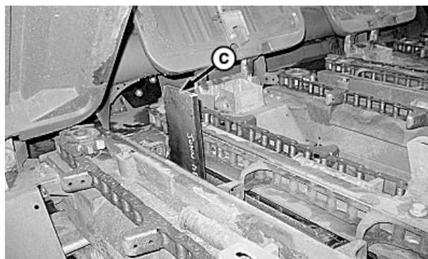
Remoção da Porca de Fixação Esquerda Exibida
