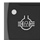
RXA0168427—UN—30MAY19 Przycisk blokady mechanizmu różnicowego
