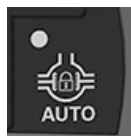
Przycisk AUTO blokady mechanizmu różnicowego
