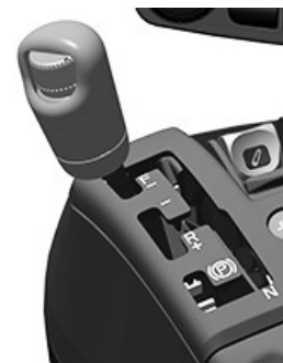
变速/换挡控制示例
