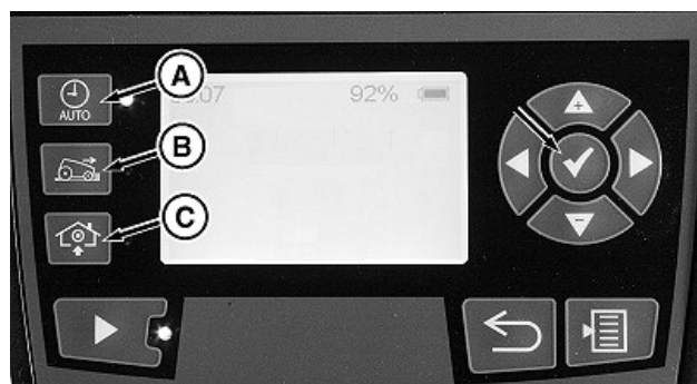
A—Slå græs efter tidsplan (AUTO) B—Tilstanden Slå nu C—Tilstanden "Gå hjem"
