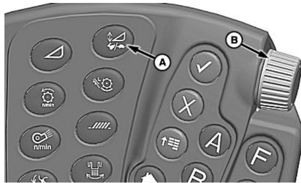
A—Selector de ajuste de sensibilidad/índice del alimentador de mies
