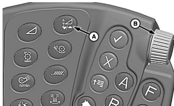
A—Interruptor de ajuste de sensibilidad/índice del alimentador de mies
