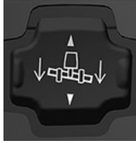
H116348—UN—19DEC16 Interruptor de Subida/ /Descida da Unidade de Colheita (Estilo B)
