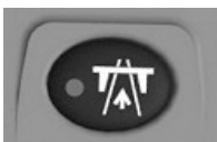
H121089—UN—15MAR17 Desconexão para Transporte em Estrada (Estilo A)
