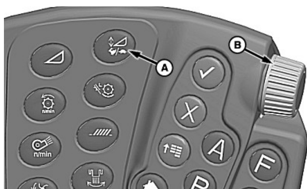
A—Interruptor de ajuste da sensibilidade/velocidade do alimentador B—Seletor
