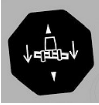
H121090—UN—15MAR17 Interruptor de Subida/ /Descida da Unidade de Colheita (Estilo A)
