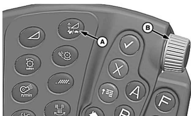
A—Contacteur de réglage de la vitesse de réaction/de la sensibilité du convoyeur d'alimentation B—Molette de sélection
