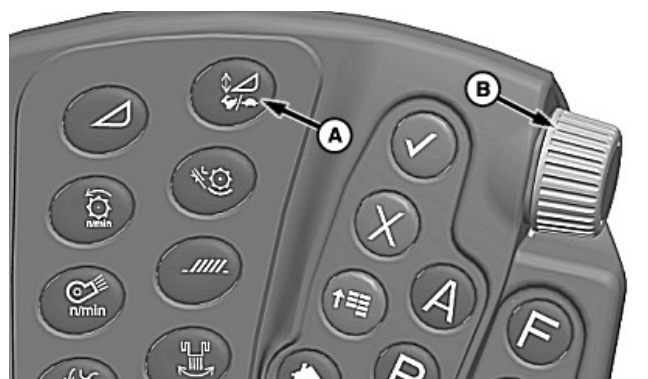
A—Contacteur de réglage de la vitesse de réaction/de la sensibilité du convoyeur d'alimentation B—Molette de sélection
