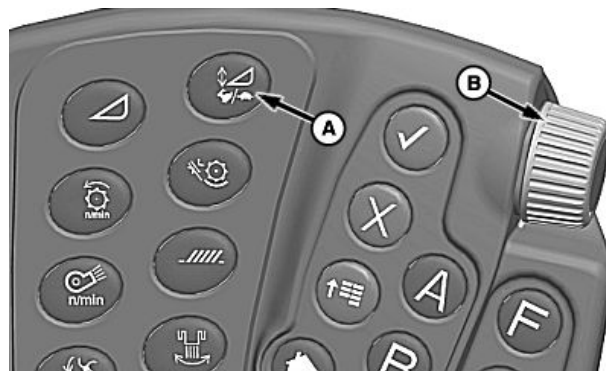
A—过桥速度/灵敏度调节开关 B—选择旋钮
