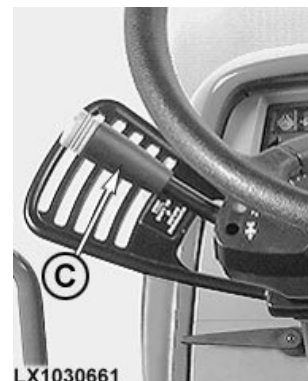
A—Palanca de cambio de grupos B—Palanca de cambio de marchas C—Reverse drive lever
